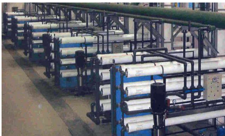
Рис. 8. Подготовка питьевой воды на заводе обратноосмотического опреснения каспийской морской воды
