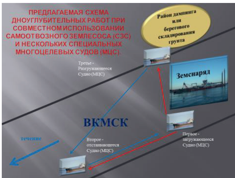
Рис. 6. Предлагаемая схема дноуглубительных работ при совместном использовании самоотвозного землесоса (СЗС) и нескольких специальных многоцелевых судов (МПС) [4]
