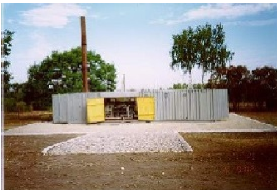
Мобильный комплекс, размещенный в 40-футовом контейнере. г. Шиханы Саратовской обл., 2002–2005 г., отработано в полевых условиях обезвреживание 37 специальных рецептур (хлор-, фтор-, серу-, фосфорсодержащих) с рекордным уровнем экологической безопасности
