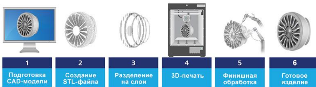
Рис. 9. Общая схема аддитивного производства
