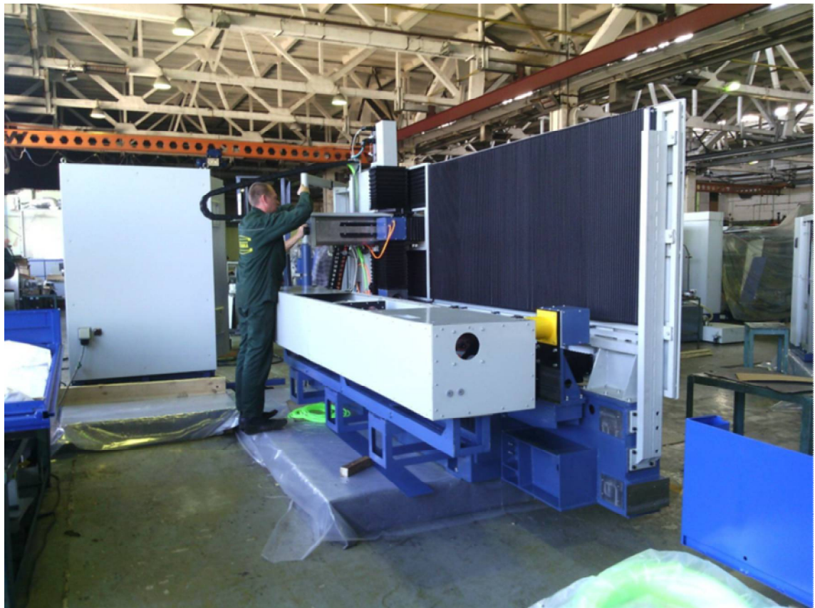
Сборка Лазерного комплекса мощностью 5 кВт.
