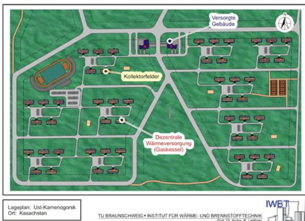
Рисунок 3 – Децентрализованная система теплоснабжения на газе жилого комплекса
